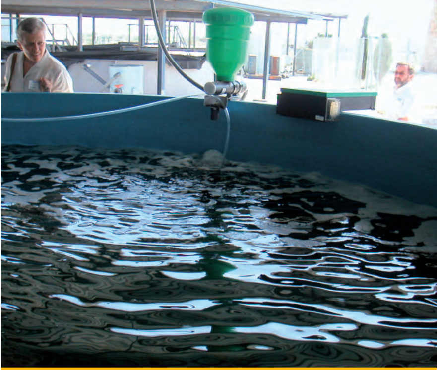
Alimentadores de tornillo y de banda (en nursery).
