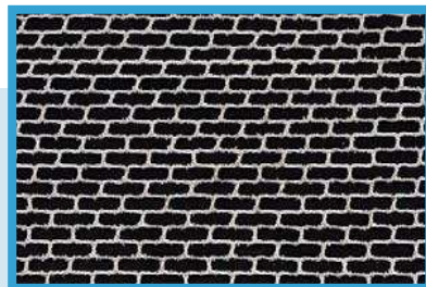
FIGURA 3.27. Deformación horizontal malla hexagonal (Global Aquafish).
