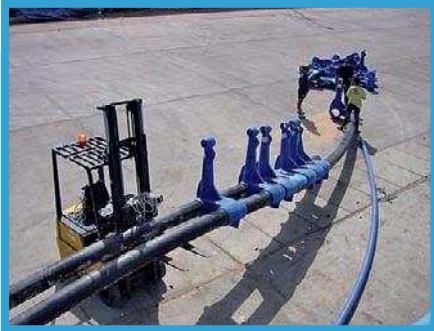
FIGURA 18.1. Montaje de los aros y soportes (Global Aquafish).
