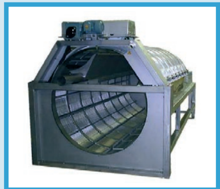
FIGURA 1.64. Filtro de tambor rotativo autolimpiable.
