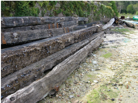
Figura 5.1. Degradación de la madera (GA).
