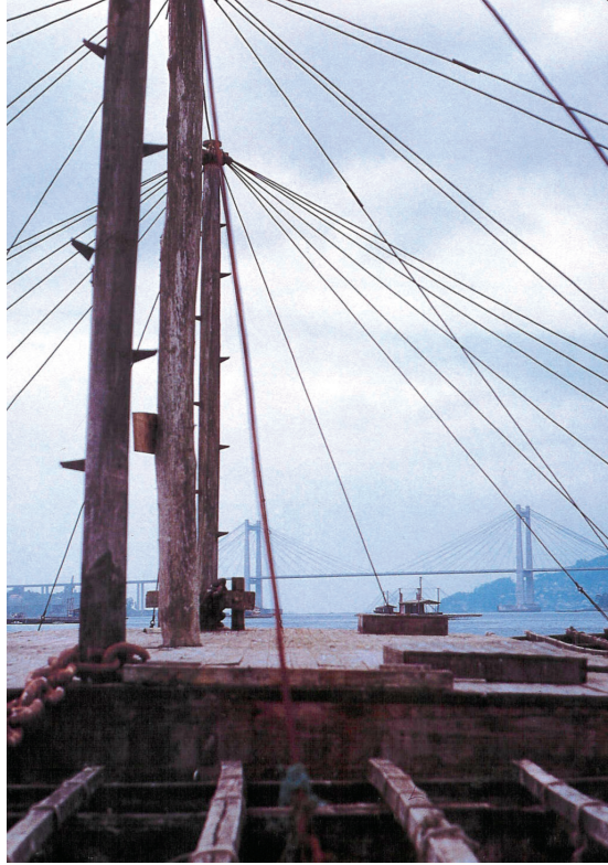
Figura 1.9. Cubierta de batea con arboladura.
